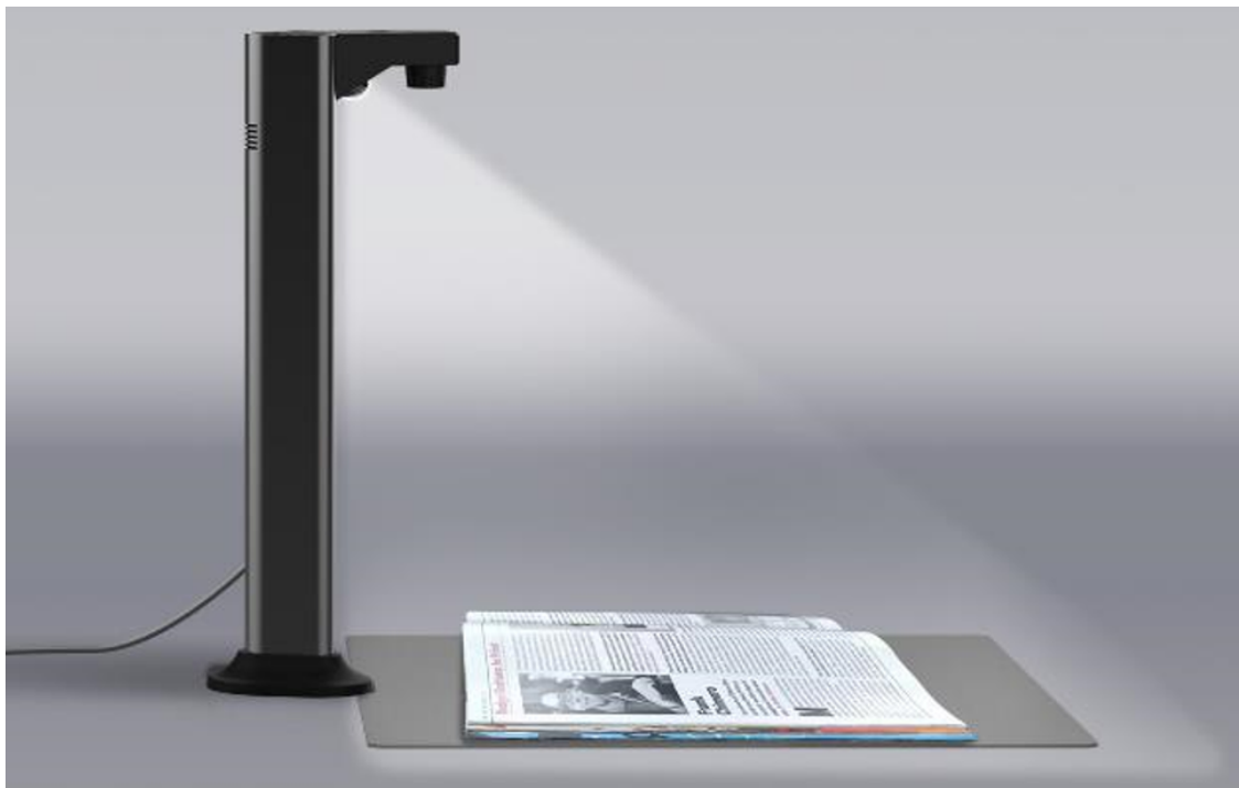
Sursa de lumină asimetrică reduce reflexiile hârtiei.
